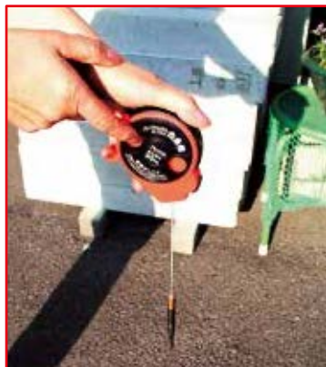
垂球付巻取器 30m (細長垂球 9φ × 120mm 付)
