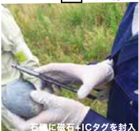
石礫に磁石+ICタグを封入
